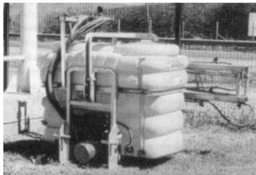
Equipo pulverizador de plaguicida, se acopla al tractor
